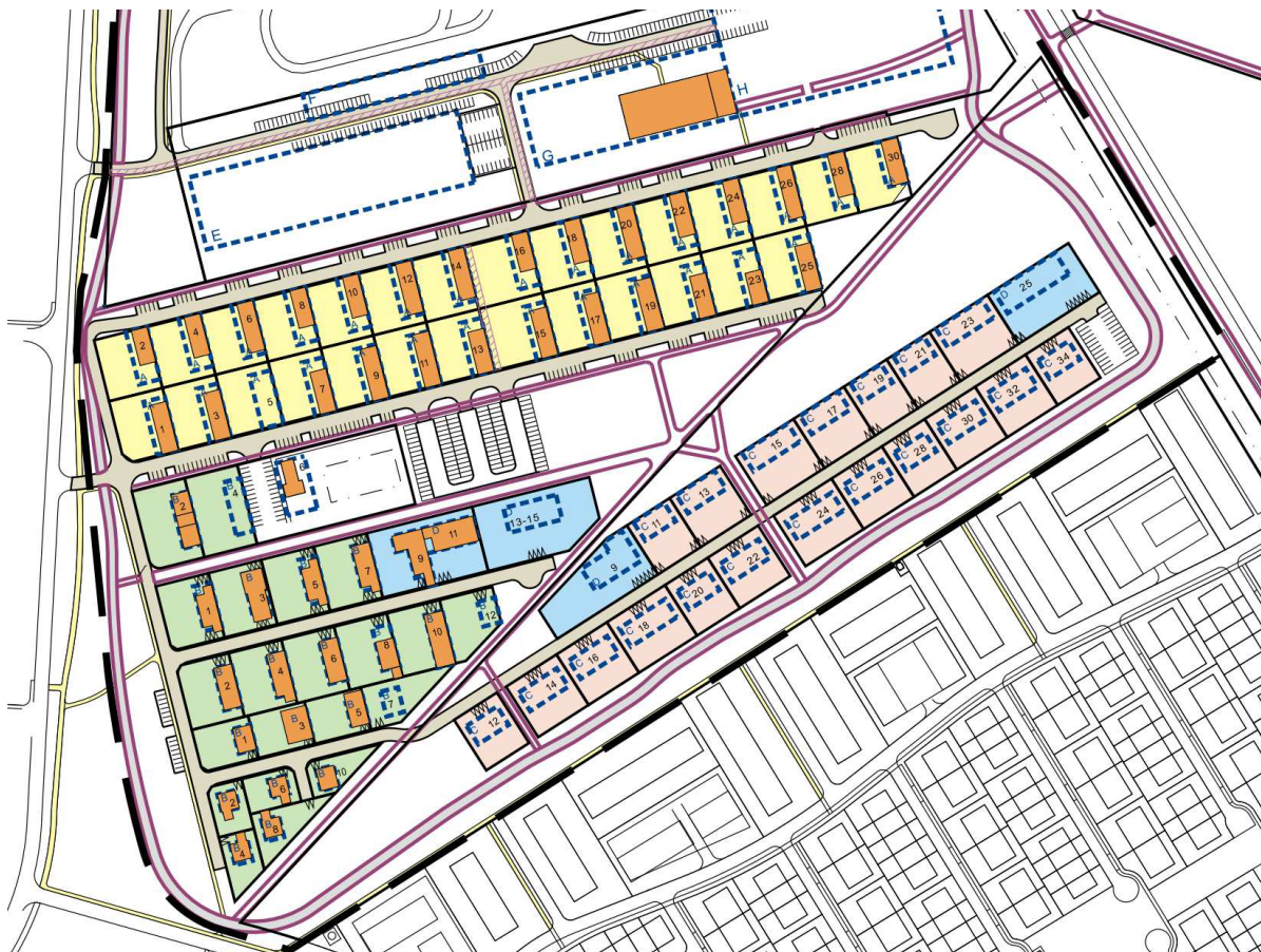
Mynd 2 – Yfirlit yfir byggingarreiti/húsagerðir hesthúsa: Gulur = A, Grænn = B, Bleikur = C og Blár = D
